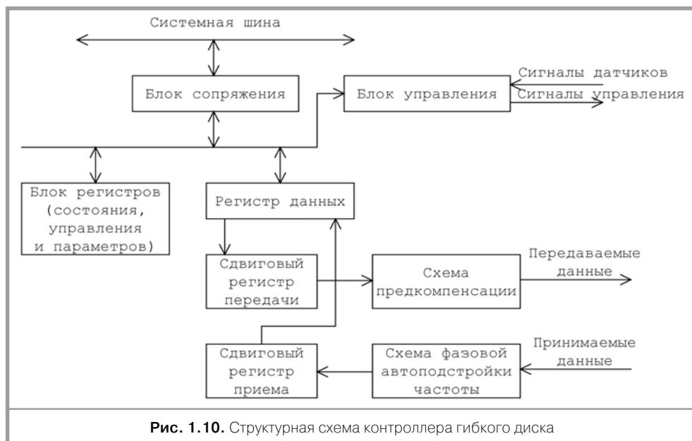
Рис. 1.10. Структурная схема контроллера гибкого диска
